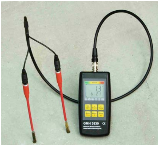
Měření vlhkosti betonu elektrodami GBSL91
