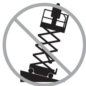
Nezvedejte plošinu, pokud stroj nestojí na pevném a rovném povrchu.
