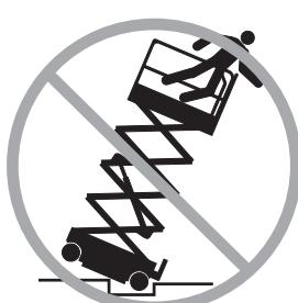
Při pojezdru stroje ve složené poloze po nerovném terénu, stavebním odpadu, nestabilním nebo kluzkém povrchu a poblíž výkopů nebo srázů dbejte maximální opatrnosti a pojízdějte nízkou rychlosť.
