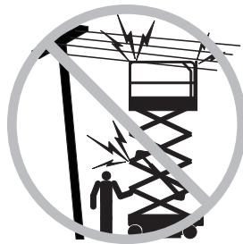
Dodržujte veškerá místní nařízení a zákony týkající se požadované bezpečné vzdálenosti od elektrického vedení. Musí být dodržována minimální požadovaná bezpečná vzdálenost dle níže uvedené tabulky.
