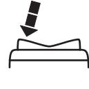
Stisknutím pravé strany kolébkového přepínače se stroj natočí ve směru označeném žlutým trojúhelníkem na panelu pro ovládání z plošiny.
