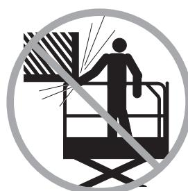
Budete-li se držet ochranného zábradlí plošiny, mějte na paměti nebezpečí sevření.
