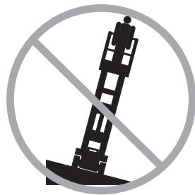
Nespoléhejte se na výstražnou signalizaci náklonu jako na indikátor roviny povrchu. Zvuková signalizace náklonu plošiny se na podvozku a na plošině spustí, až když bude stroj na prudkém svahu.
