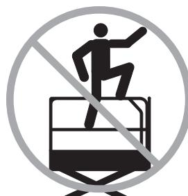
Na ochranné zábradlí plošiny si nesedejte, nestoupejte na ně ani po něm nešplhejte. Vždy pevně stůjte na podlaze plošiny.
