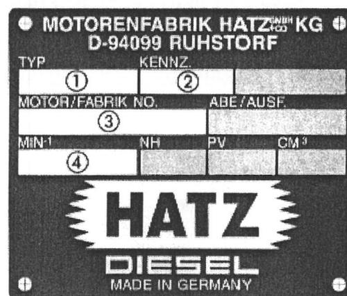
Obr. Výrobní číslo motoru HATZ
